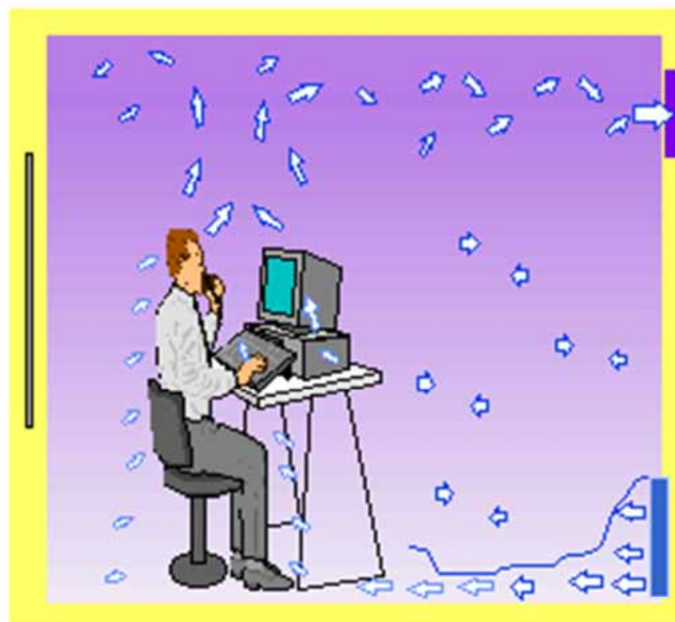
Displacement ventilation (DV)
