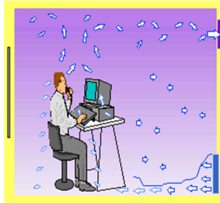
Displacement ventilation (DV)
