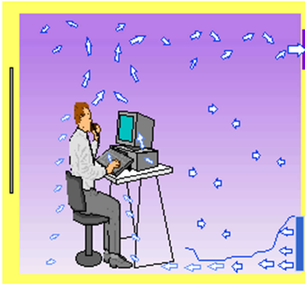
Displacement ventilation (DV)
