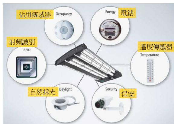
圖12 智能燈具可以整合各種傳感器(來源: www.ledsmagazine.com )
