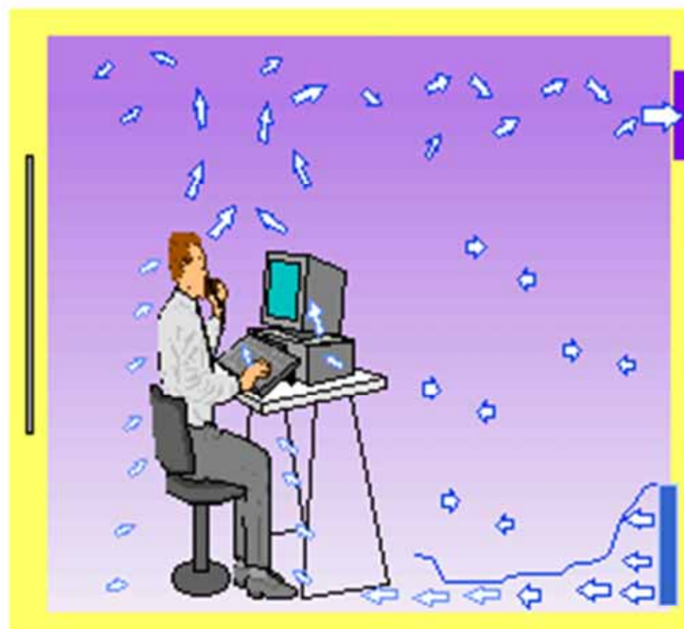
Displacement ventilation (DV)
