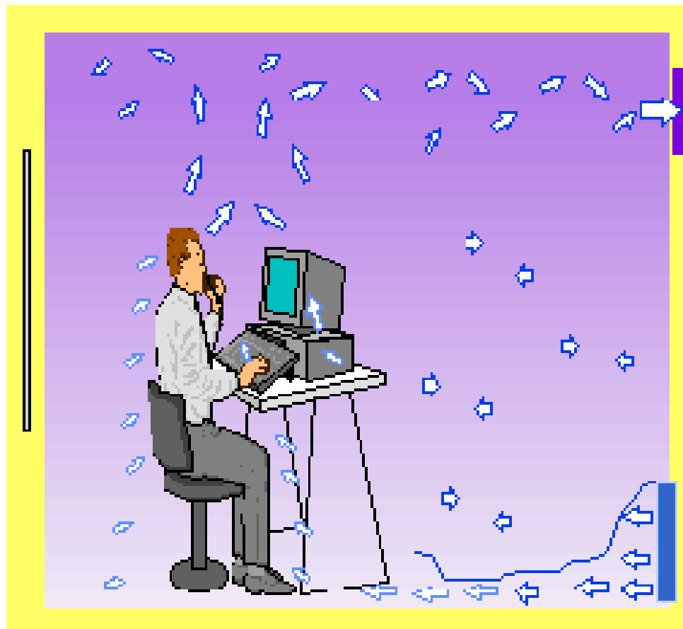
Displacement ventilation (DV)
